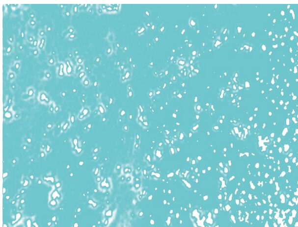
Рисунок 3 – Микрофотография кристаллов парафинов нефти Акшабулак с присадкой ДП-СМАО при 10°С
